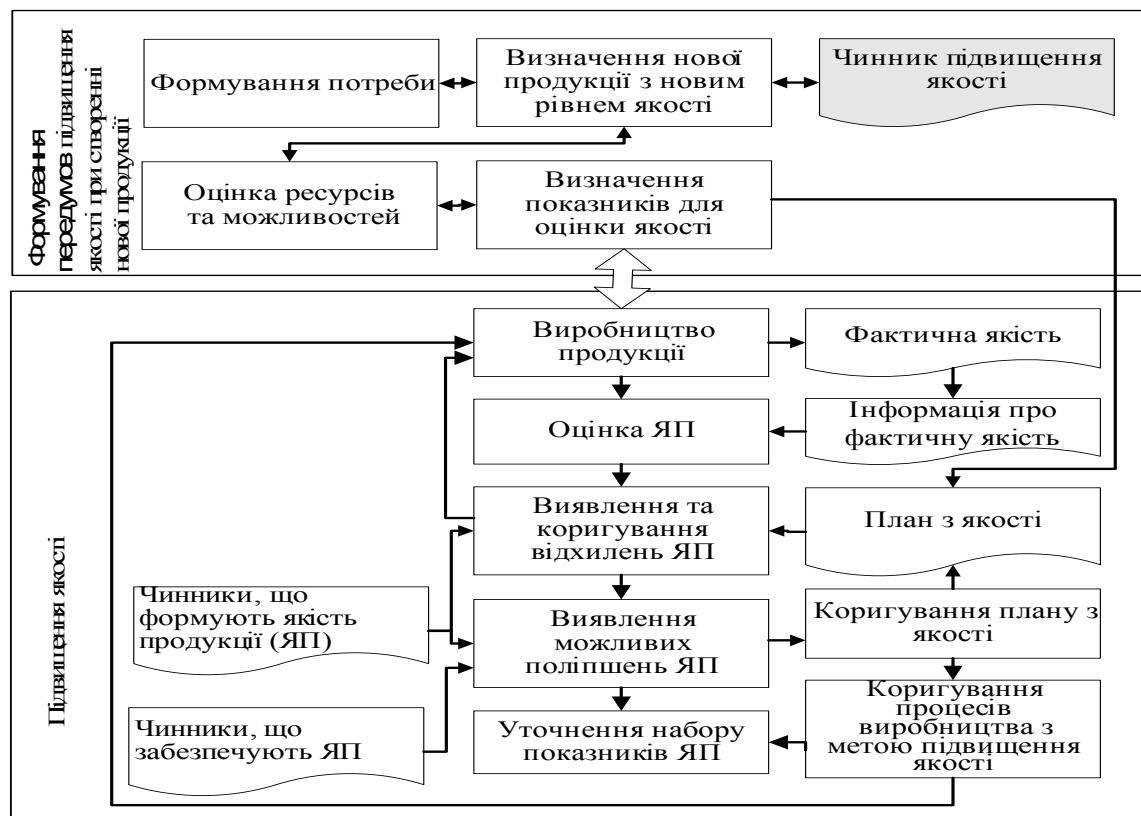
Рисунок 1 - Схема інтегрованого процесу підвищення якості продукції промислового підприємства
