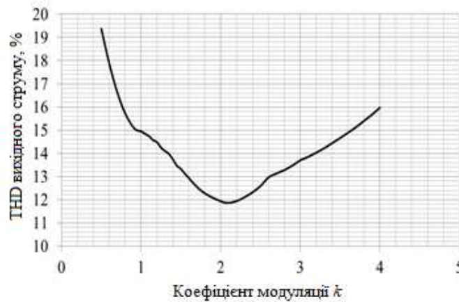
Рис. 15. Залежність ТНД вихідного струму від коефіцієнта модуляції
