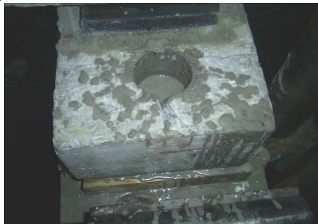
Рис. 1 Дослідження розтікання суміші полімерцементного композиту в моделі зазору між плитою БМП і балкою мосту: а - модель зазору до встановлення плити; б - заливання суміші у зазор через отвір у плиті
