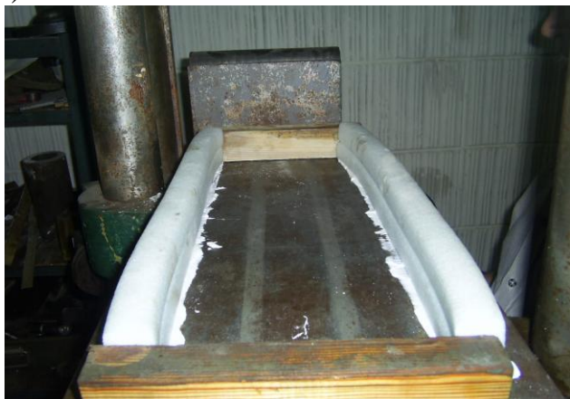
Рис. 1 Дослідження розтікання суміші полімерцементного композиту в моделі зазору між плитою БМП і балкою мосту: а - модель зазору до встановлення плити; б - заливання суміші у зазор через отвір у плиті
