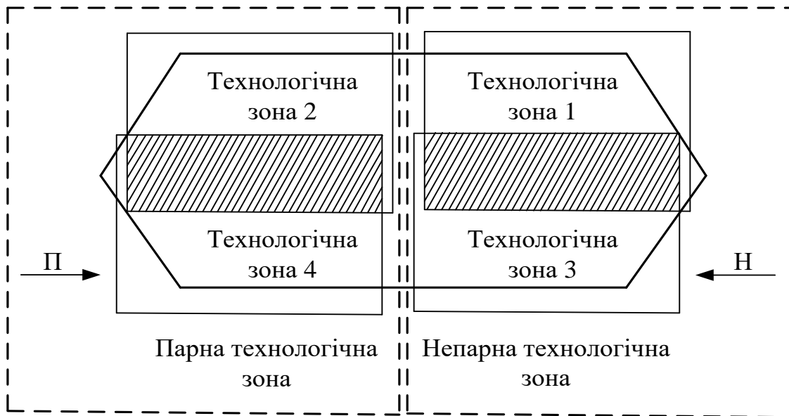
Рис. 2.11. Схема технологічних зон станції двоколійної ділянки
