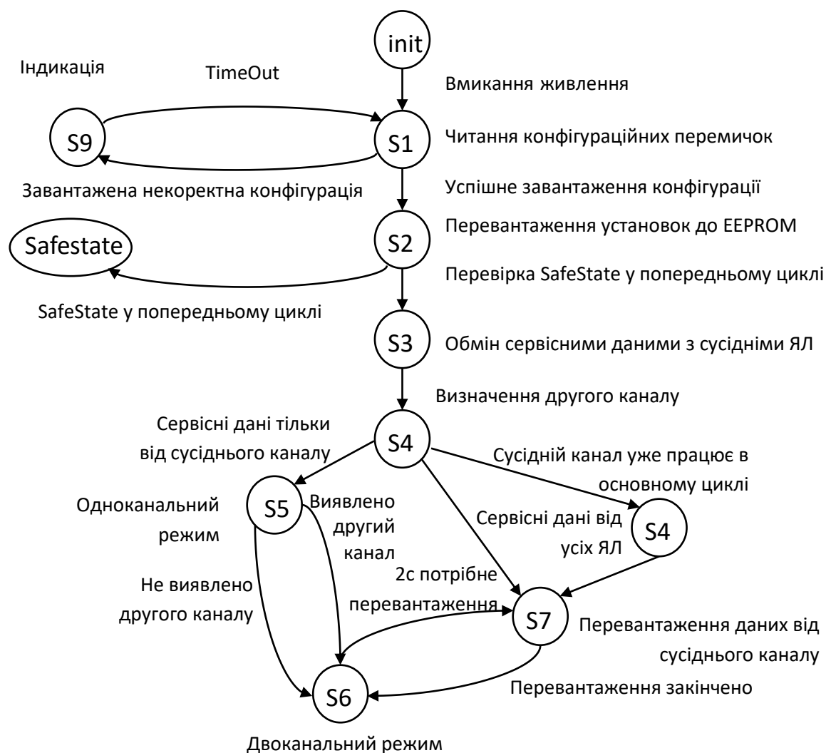
Рис. 2.23. Діаграма станів автомата FSM_Start_A_ea
