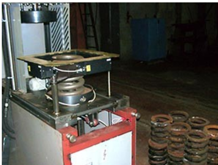
Рисунок 3.4 – Загальний вигляд стенда для вимірювання параметрів пружин, що працює за триангуляційним принципом
