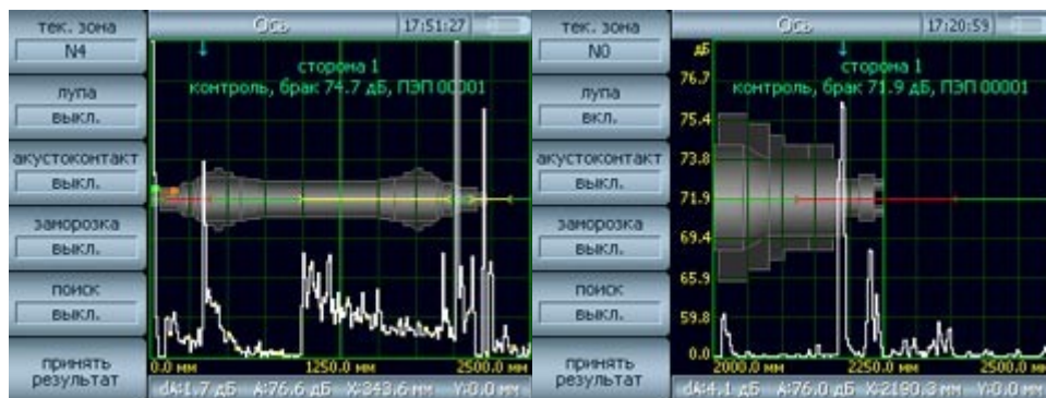
Рисунок 2.37 – Контроль осей колісних пар комплексом «Томографік 2.1»
