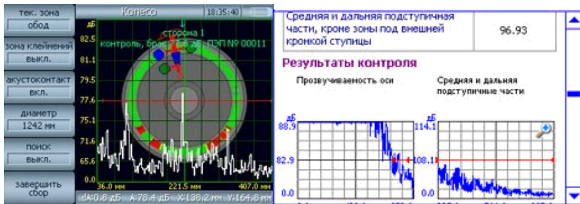
Рисунок 2.38 – Контроль приобідної зони дисків суцільнокатаних коліс за допомогою УСК-4Т, УСК-5Т
