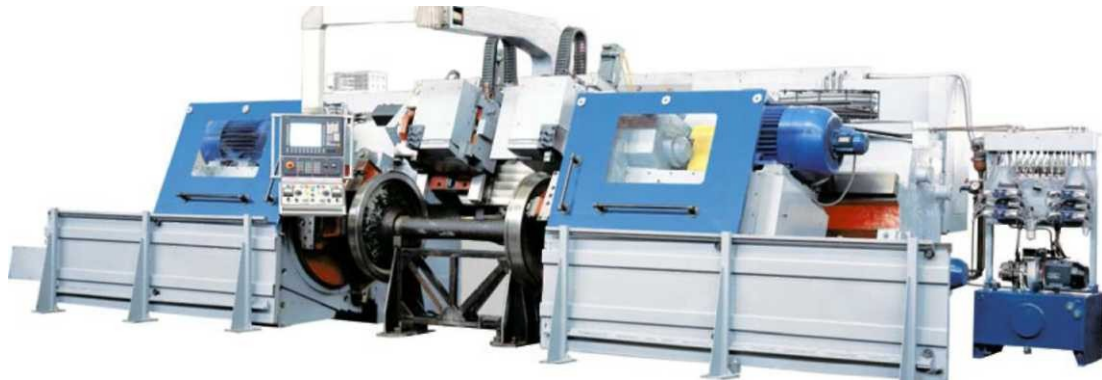
Рисунок 2.15 – Верстат для обробки вагонних коліс підвищеної твердості моделі РТ905Ф3
