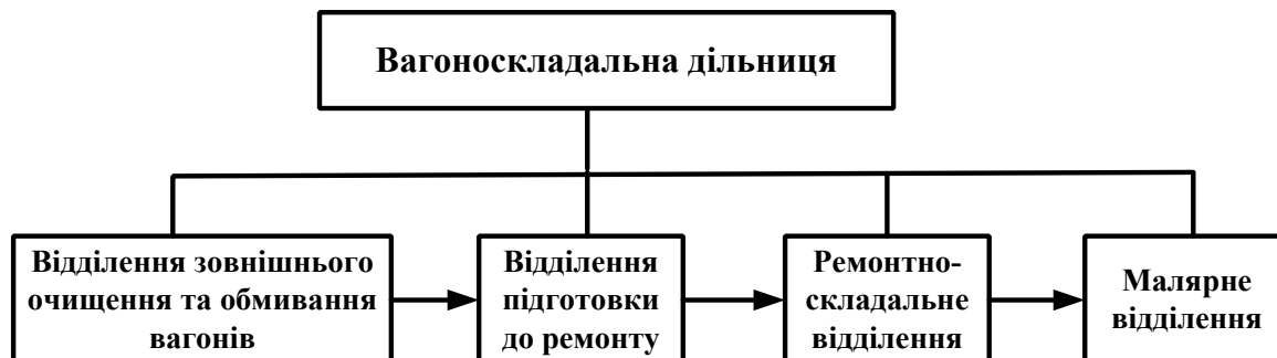
Рисунок 6 – Виробнича структура вагоноскладальної дільниці
