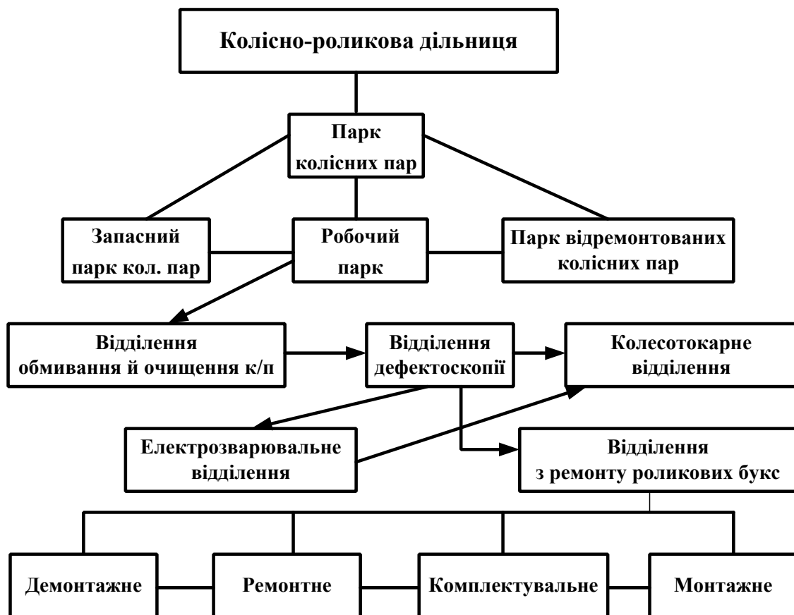
Рисунок 9 – Виробнича структура відділення ремонту колісних пар та буксових вузлів
