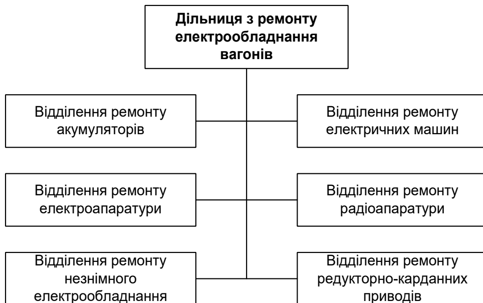
Рисунок 20 – Виробнича структура дільниці з ремонту електрообладнання пасажирських вагонів
