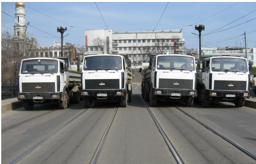
Рис. 44. Випробування Лопанського мосту в Харкові автомобілями МАЗ 555102-223, середня вага автомобілів 19,1 тс
