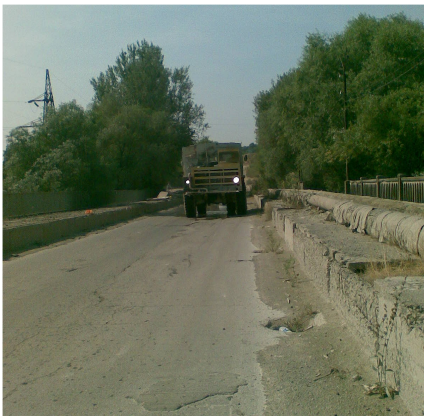
Рис. 41. Випробування автомобільного мосту автомобілем Белаз-75485 загальною масою 65 т
