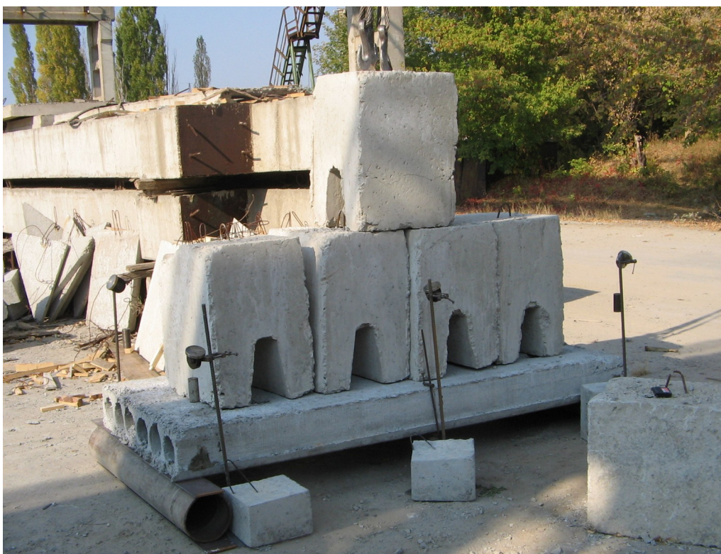
Рис. 29. Випробування пустотілої плити довжиною 3 м дрібними вантажами
