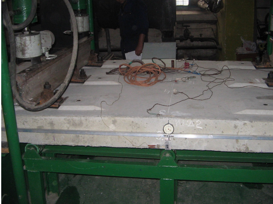
Рис. 58. Визначення прогину плити безбаластного мостового полотна за допомогою індикатора
