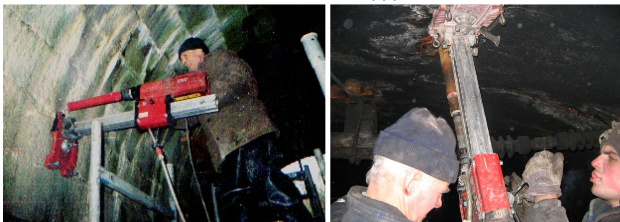
Рис. 6. Відбір зразків бетону за допомогою свердильної установки NORTON CB 2000
