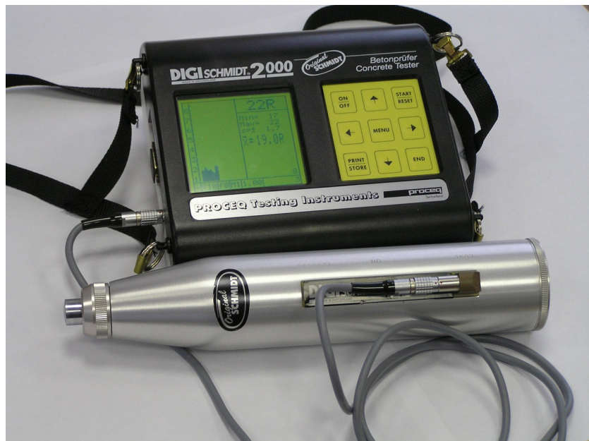
Рис. 20. Молоток для випробувань бетону DIGI- Schmidt 2
