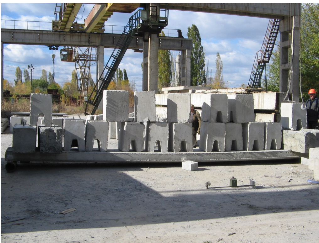
Рис. 29. Випробування пустотілої плити довжиною 3 м дрібними вантажами
