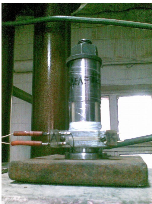
Рис. 70. Динамометр для визначення зусилля обтиснення у високоміцних шпильках при обтисненні плит безбаластного мостового полотна
