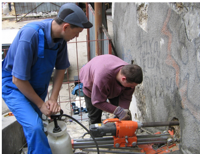
Рис. 6. Відбір зразків бетону за допомогою свердильної установки NORTON CB 2000
