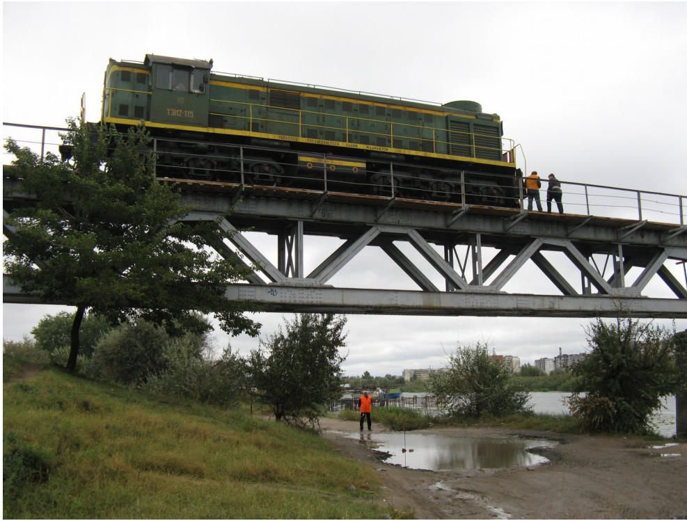
Рис. 47. Випробування металеві прогонової будови з наскрізними фермами з їздою зверху тепловозом ТЭМ2-119
