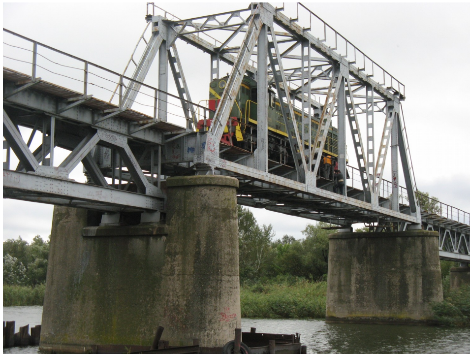
Рис. 48. Випробування металеві прогонової будови з наскрізними фермами з їздою низом тепловозом ТЭМ2-119
