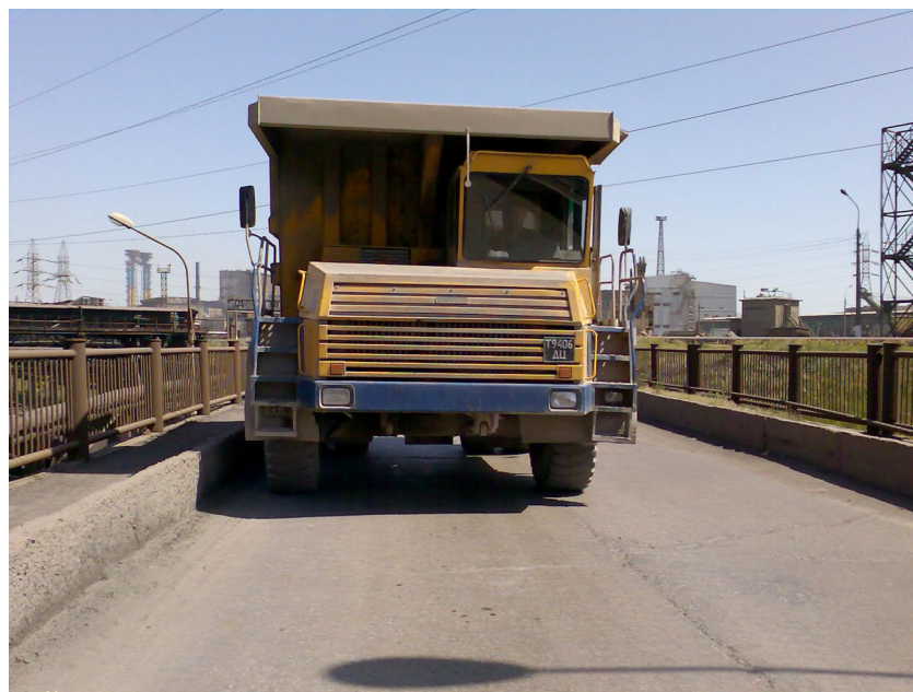
Рис. 42. Випробування шляхопроводу автомобілем Белаз-540 загальною масою 25,5 т
