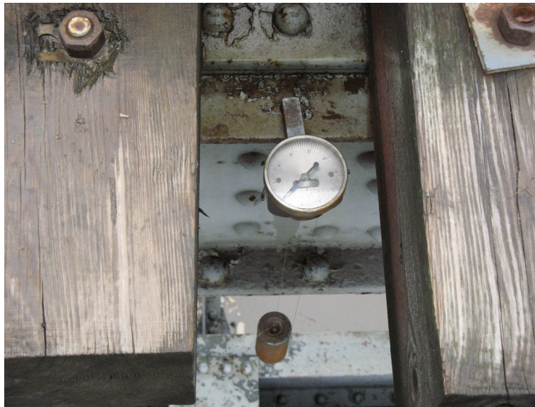
Рис. 53. Встановлення прогиномірів із дротовим зв'язком за схемами рис. 52, б, в
