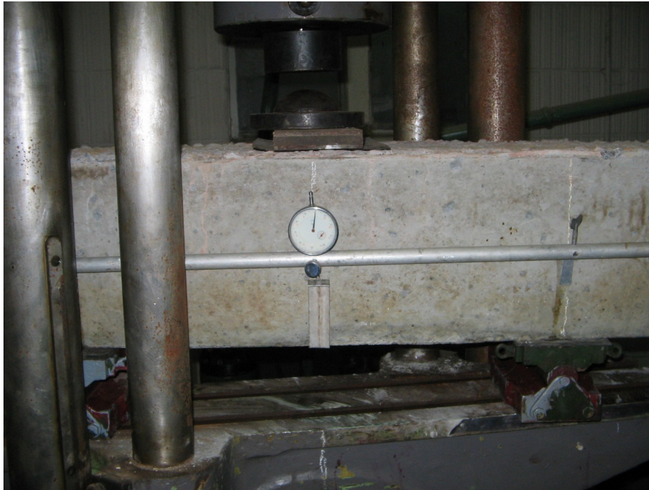
Рис. 59. Визначення прогину залізобетонної балки за допомогою індикатора
