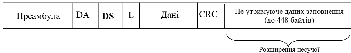
Рисунок 5.5 – Розширення несучої в Gigabit Ethernet
