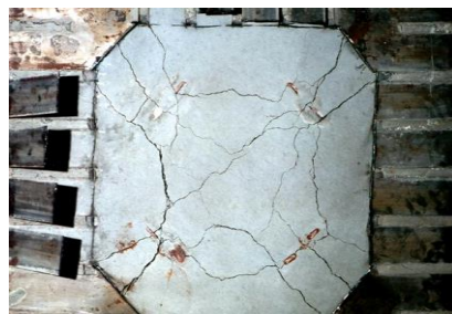
Рис. 21. Руйнування дослідних зразків: а – колона зі складеною обіймою, б – розтягнута зона плити СБКП
