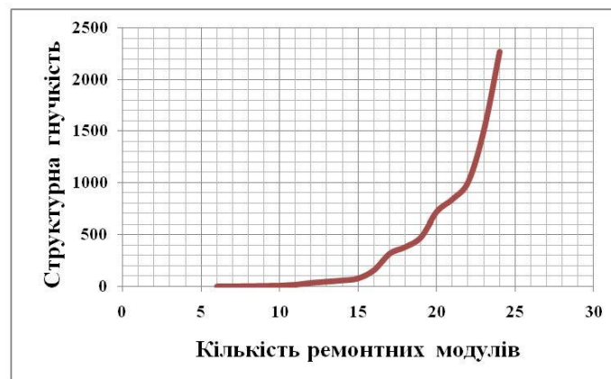
Рисунок 14 – Графік залежності структурної гнучкості потоку від кількості ремонтних модулів
