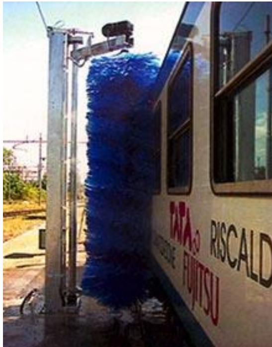
Рис. 5.13. Бічна вертикальна щітка мийної установки
