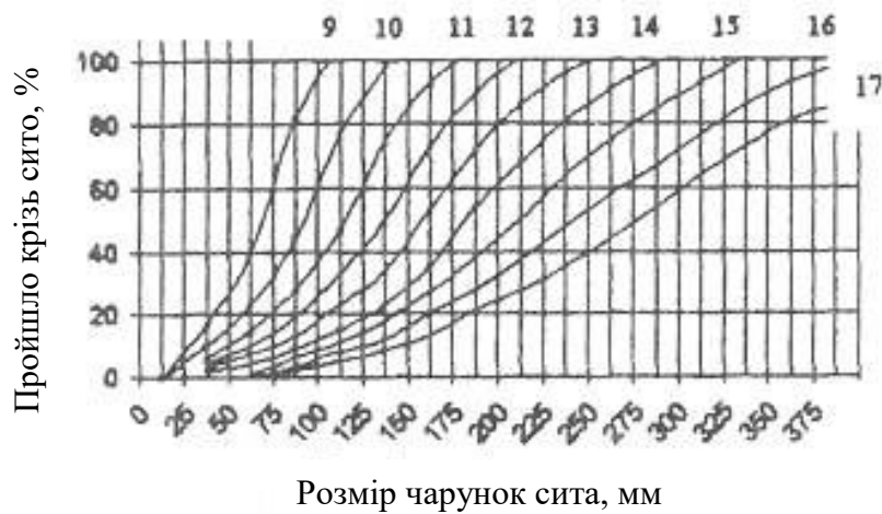
Рисунок 5 – Графік гранулометричного складу продукту дроблення конусних дробарок для середнього дроблення
