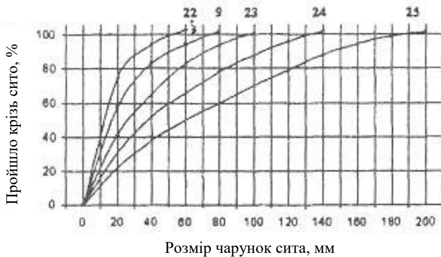
Рисунок 6 – Графік гранулометричного складу продукту дроблення роторних дробарок для великого дроблення
