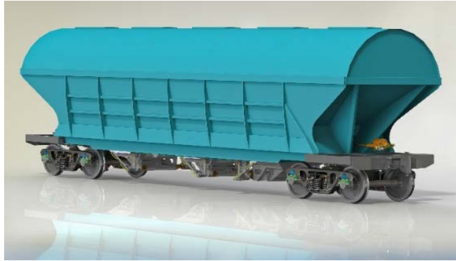
Рис. 10 – Хопер-зерновоз перспективної конструкції
