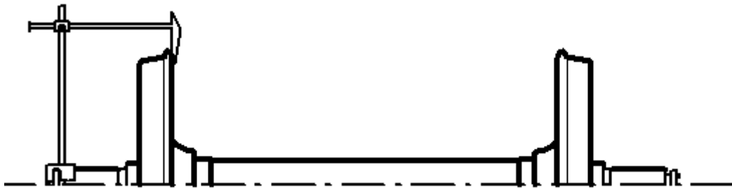
Рисунок 1.1 – Схема положення штихмаса при вимірюванні відстані між внутрішніми гранями ободів коліс
