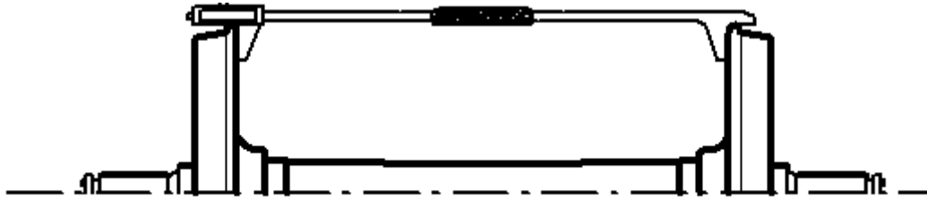
Рисунок 1.1 – Схема положення штихмаса при вимірюванні відстані між внутрішніми гранями ободів коліс
