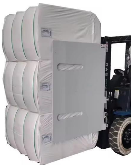
Рис. 2. Захоплювачі для кіп із бічними затискачами
