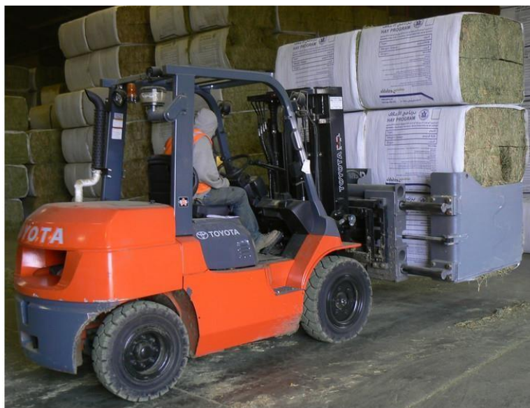
Рис. 2. Захоплювачі для кіп із бічними затискачами
