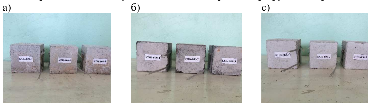
Рисунок 2 – Зразки підготовлені до випробувань: а) кубіки з додаванням базальтової фібри; б) кубіки з додаванням сталевією фібри; в) кубіки без фібри.
