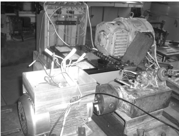
Рис. 4. Вентильный индукторно-реактивный двигатель, спаренный с делительной головкой
