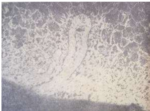
Рисунок 1 – Знеуглецьований шар на поверхні катання рейки
