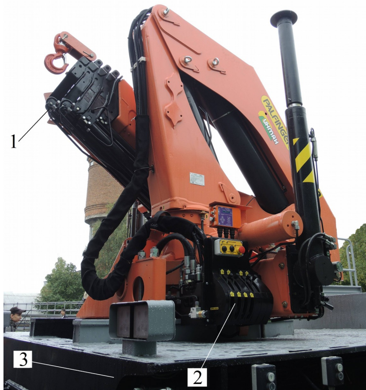
Рис. 5.13. Кран-маніпулятор Palfinger у транспортному положенні:
