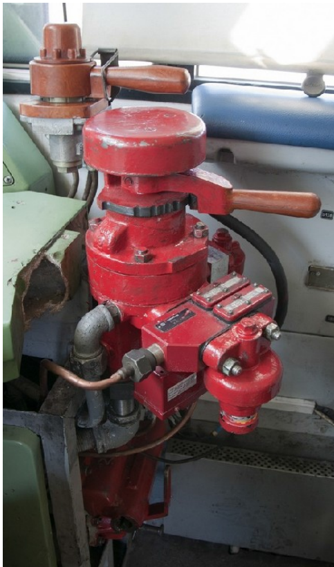
Рис. 4.17. Кран машиніста № 395 (автодрезина ДГКу): 1 – нижня частина корпусу; 2 – редуктор; 3 – середня частина корпусу; 4 – кришка; 5 – рукоятка; 6 – електричний контролер; 7 – рознімач; 8 – стабілізатор тиску
