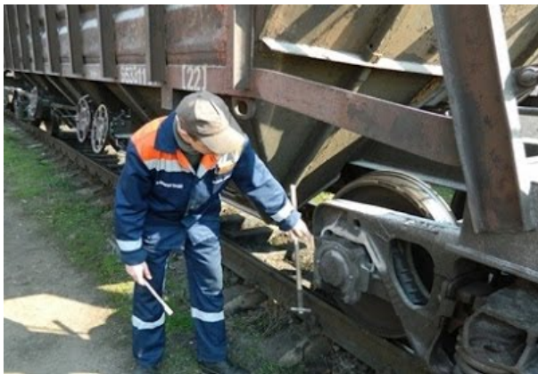
Рис. 1. Органолептичне діагностування вагонів оглядачем під час зупинки
