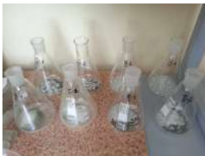
Рис. 1. Моделювання поверхневих стоків із використанням зразків цеолітів різних фракцій
