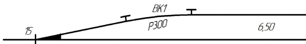
Рисунок 4.1 – З'єднання двох паралельних колій при \text{tg} \alpha_{15} \approx 1/9 , e = 6,50 м і радіусі захрестовинної кривої 300 м
